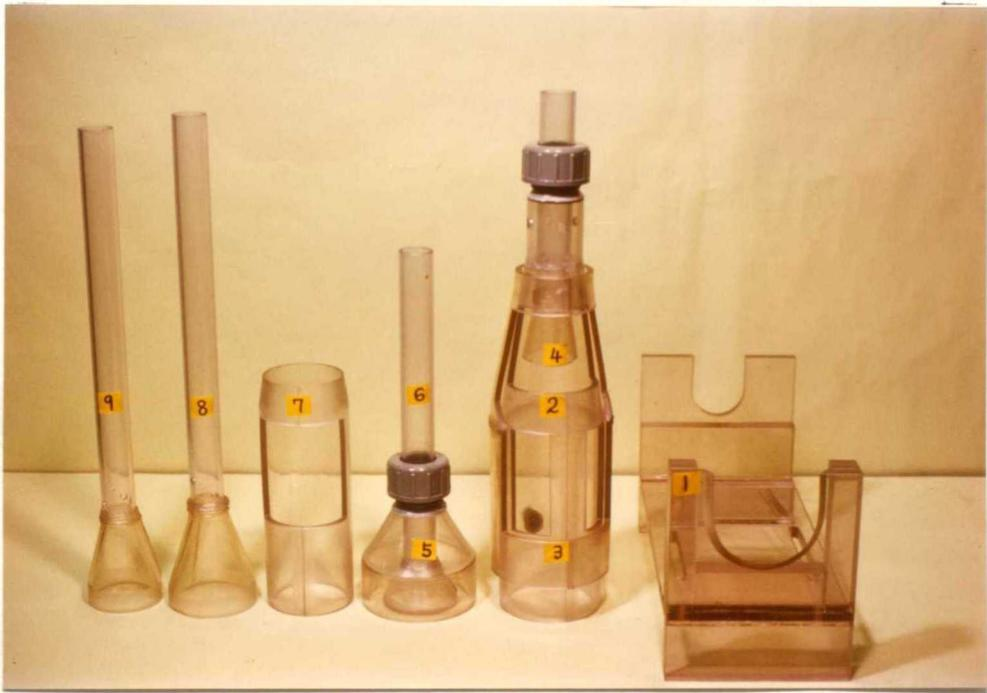
写真5 ラット無麻酔頸静脈・尾静脈穿刺採血用保定器の部品
