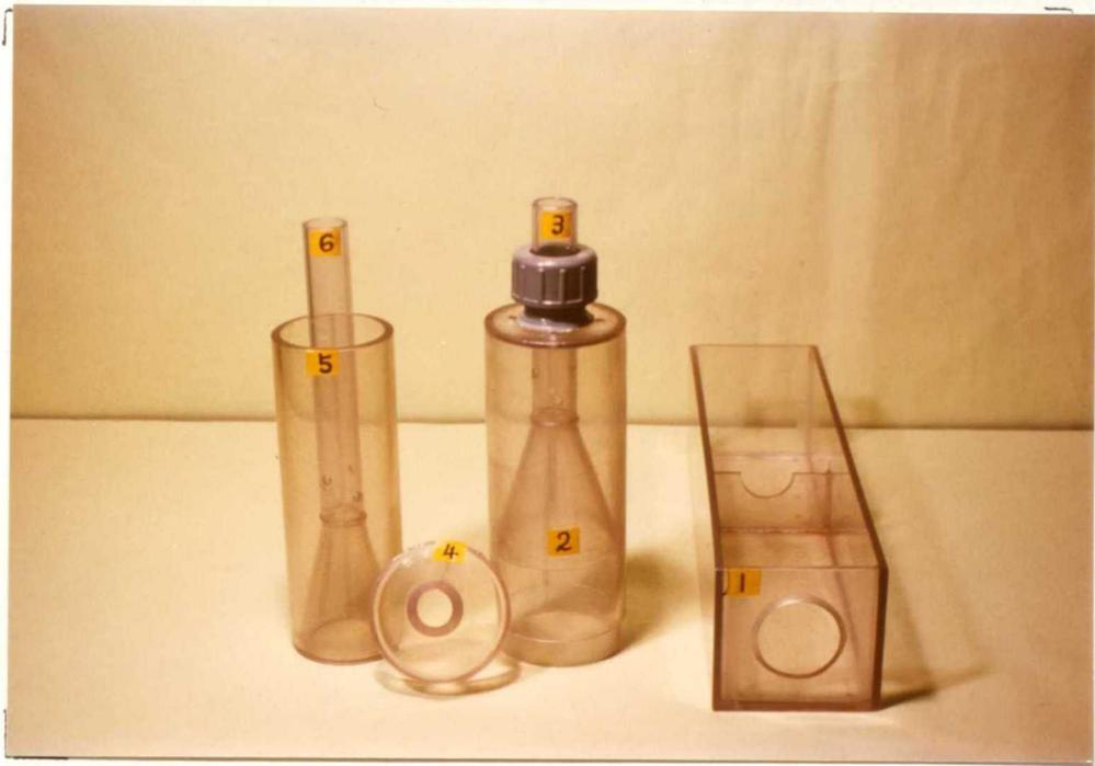
写真1 ラット無麻酔尾静脈穿刺採血用保定器の部品
